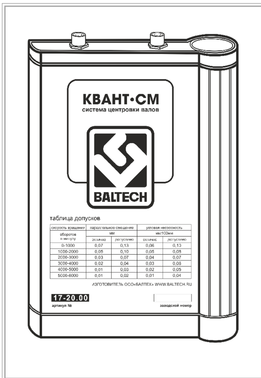
Рис. 3-5. Задняя панель вычислительного блока.
