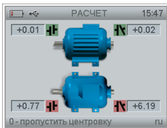
Рис. 4-36. Вид окна «Расчет» для горизонтальной машины.
