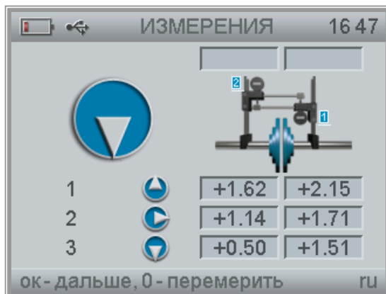
Рис. 4-51. Вид окна «Измерения» для валопровода при методе обратных индикаторов.
