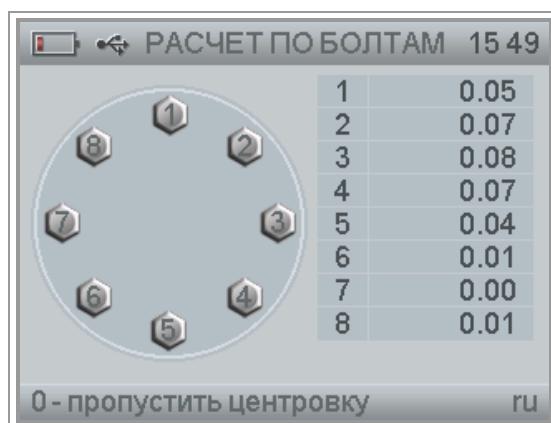
Рис. 4-38. Вид окна «Расчет по болтам».
